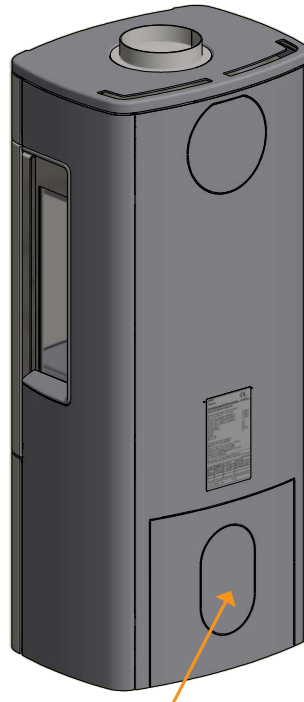
Afdekplaat moet verwijderd worden
